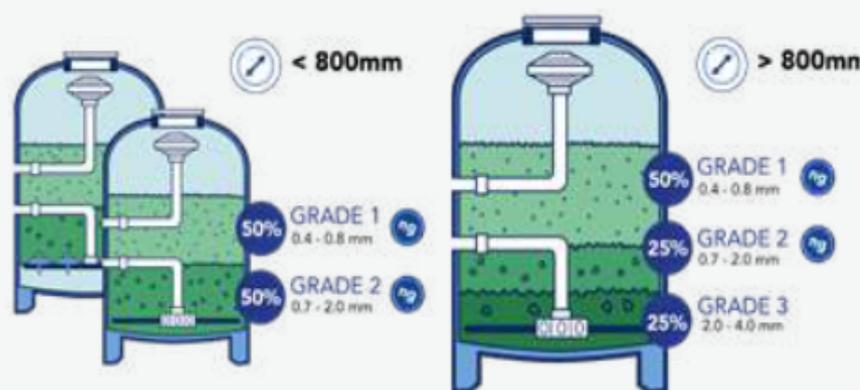
**Pour les petits filtres (diamètre < Ø 800 mm) ou tous les filtres avec plancher porte-buses, indépendamment de la taille du filtre:**
